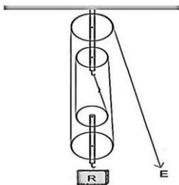
ب- در شکل مقابل اگر شخصی طناب قرقره را ۶ متر به سمت پایین بکشد جسم ( نیروی مقاوم R ) چند متر به سمت بالا کشیده می شود ؟ (.....متر)
